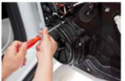
6本のピースでとまっている純正6インチスピーカーを外していく。ちなみに原車両の純正スピーカーは80WATだつ。
