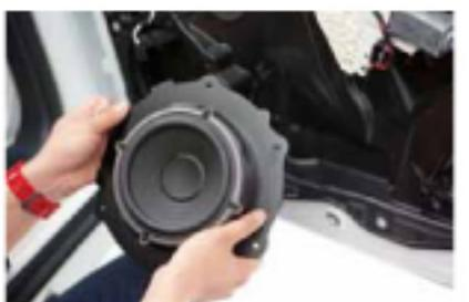
サイズ、形状ともに完全に純正と同じに設計されたピュアトーン/素材の専用「リフ」を、既存のスピーカーと組み合せせる。
